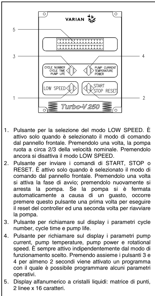
Pannello frontale dell'Hand Held Terminal
